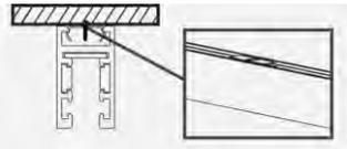
шинопровод крепится к поверхности на клипсы
